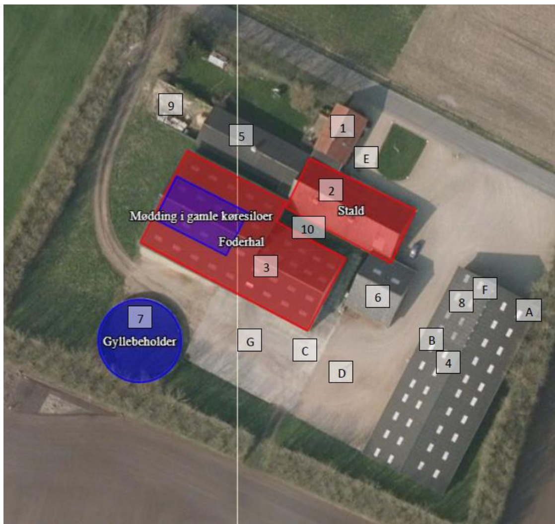
Kort 2: Situationsplan. A: Dieseltank, B: Kemikalier, C: Døde dyr, D: Markvandsboring, E: Drikkevandsboring, F: Affald, G: Betonplads
